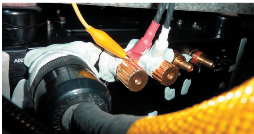
Dentatura sulla parte metallica della connessione a forcella (canale destro) in basso: sul canale sinistro
